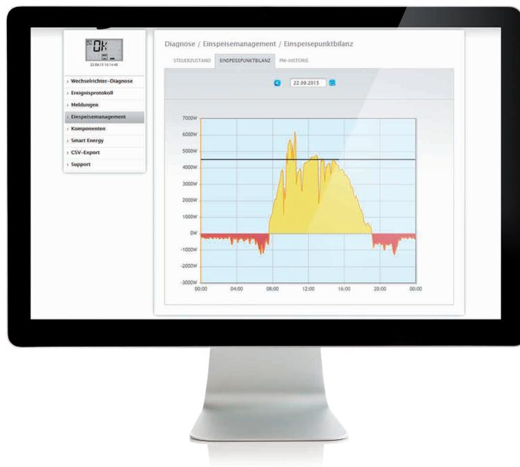
**Einspeisemanagement – Einspeisepunktbilanz:** In diesem Diagramm wird auf einen Blick ersichtlich, wann welche Leistung ins öffentliche Netz eingespeist und wann welche Leistung aus dem Netz bezogen wurde. Die negativen (rot) Werte stellen den Bezug aus dem Netz dar und die positiven (gelb) Werte die Einspeisung ins Netz.
