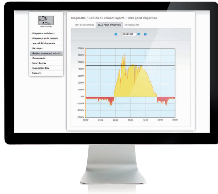
Gestion de l'injection - Bilan de l'injection: Sur ce diagramme on peut voir à quel moment la production a été injectée sur le réseau et à quel moment il y a eu soutirage. Les valeurs négatives montrent le soutirage et les valeurs positives montrent l'injection.
