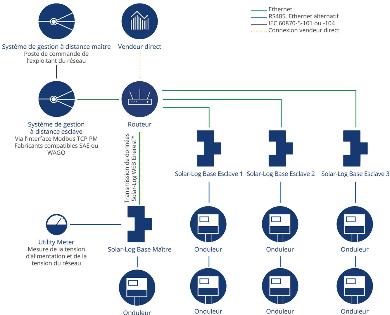
Les signaux de l'exploitant de réseau sont reçus par le Solar-Log Base 2000 (maître) et ventilés sur les onduleurs connectés via les Solar-Log Base 2000 (esclaves). Pour cette architecture, le Solar-Log™ maître peut être couplé en réseau à un maximum de neuf esclaves. La mise en réseau des appareils Solar-Log™ permet de répondre à des demandes complexes (plusieurs parties de l'installation et points d'injection et de nombreux fabricants d'onduleurs).
