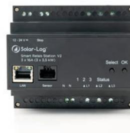
La communication entre la Solar-Log™ Smart Relais Station V2 et les appareils Solar-Log™ se fait par l'interface réseau RJ45 (TCP/IP).
