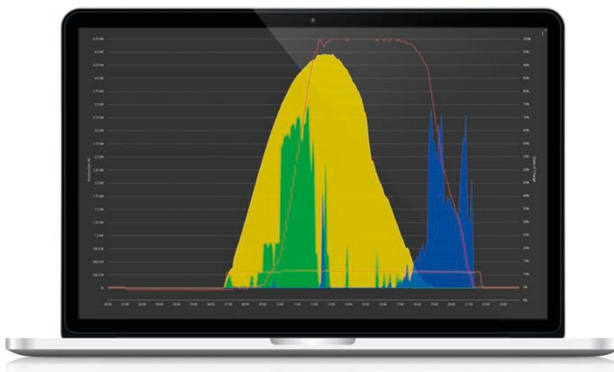
Aperçu journalier : La batterie de stockage est chargée avec le surplus de production de l'installation photovoltaïque (vert) et déchargée en cas de besoin (bleu foncé) pour éviter le soutirage sur le réseau.
