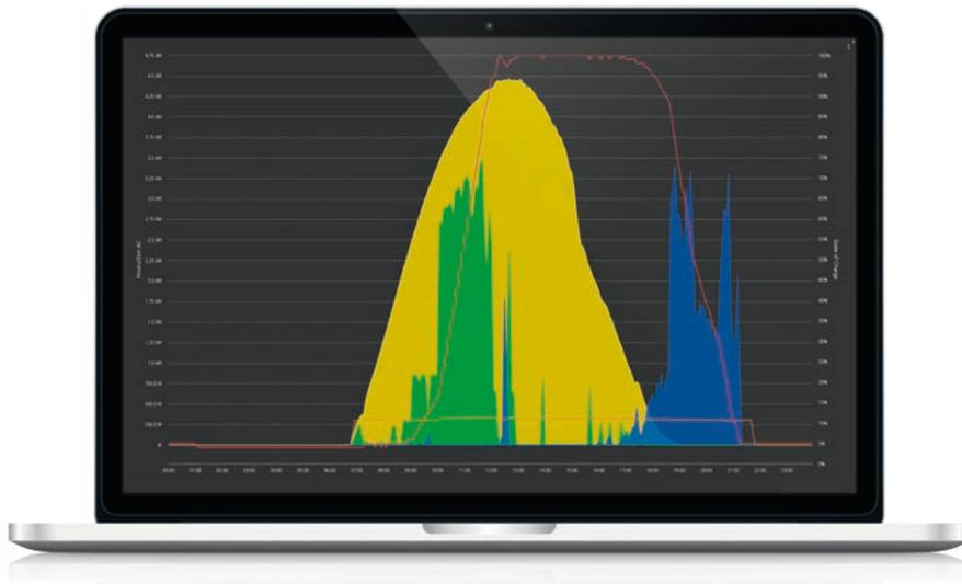
Visualizzazione diurna L'accumulatore a batteria viene caricato con la potenza in eccesso dell'impianto FV (viola) e all'occorrenza viene scaricato (azzurro) per evitare l'acquisto dalla rete.
