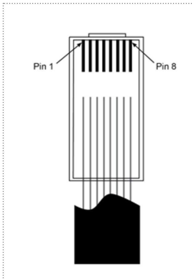
Abb.: Pinbelegung RJ45 Stecker
