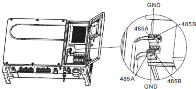
Abb.: Klemmleiste im Wechselrichter
