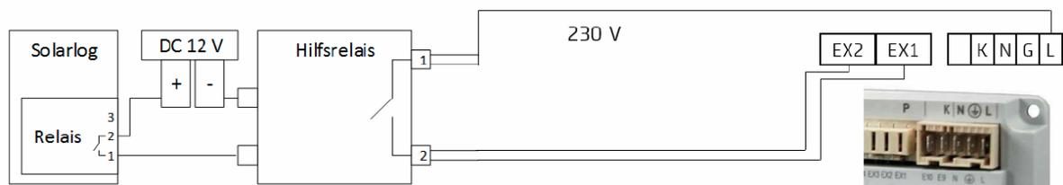
Abb.: Anbindung der Ansteuerung an das Hilfsrelais
