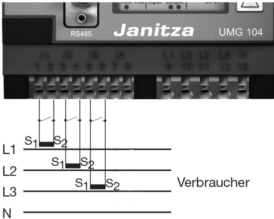
Abb.: Beispiel - Anschlusschema Strommessung UMG 104 Utility Meter mit Messwandlern
