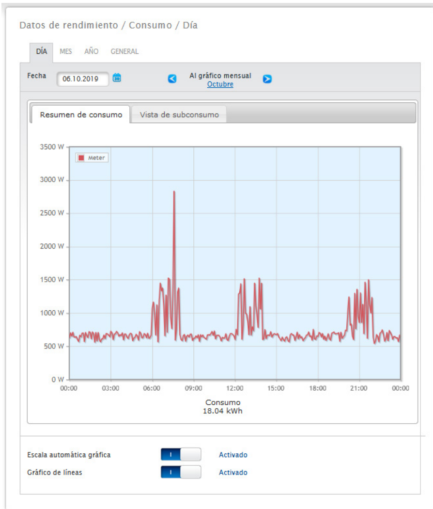
Fig.: Diagrama de consumo diario con contadores conectados y gráfico de líneas activado
