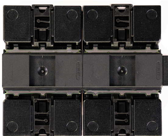
Fig.: Solar-Log Base y Solar-Log MOD I/O con conectores de bus ensamblados
