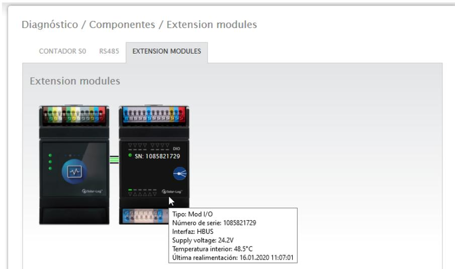
Fig.: Comunicación entre el Solar-Log MOD I/O y el Solar-Log Base
