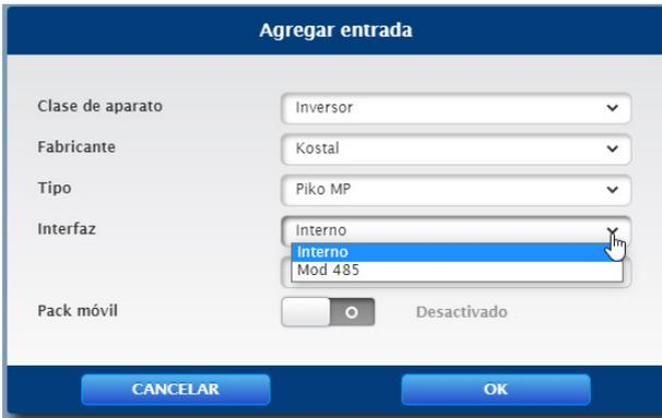
Fig.: Ejemplo- Selección de la interfaz del Solar-Log Base (interno) y del MOD 485 (Mod 485)
