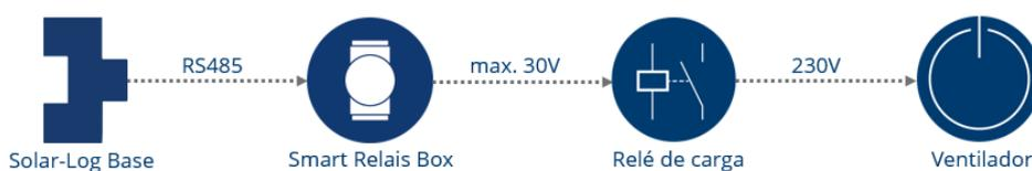
Representación esquemática del control de ventilador (para el esquema de circuitos, véanse los anexos).
