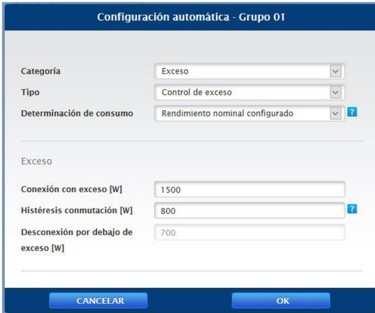
Fig.: Ventana de configuración de la lógica de control
