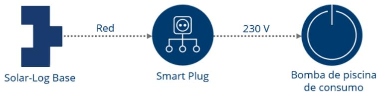
Estructura esquemática del sistema (para el esquema de circuitos, véanse los anexos).
